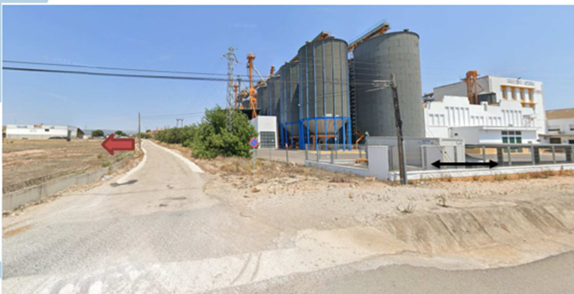
Fletxa vermella: poste a desplaçar 70cm allunyant-se de l'eix del camí. Fletxa negra: sentit de les riostres paral·leles a la circulació, no perpendiculars.
